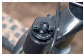
Handige knop voor de veerwegverstelling van de Reba U-Turn.
