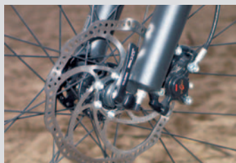
Lekker veel remkracht met de 180 mm-schijven voor.
